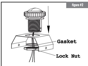
2. Vissez le capteur sur le couvercle du boîtier du capteur.
