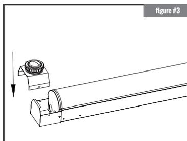
3. Fixez le couvercle du boîtier du capteur.
