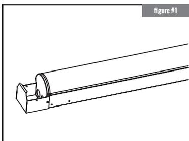
1. Défoncez la pièce prédécoupée du capuchon d'extrémité. Vissez le boîtier de capteur fourni à l'extrémité du boîtier.
