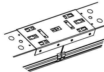
STEP 1: Visser le support à l'extrémité des luminaires.
